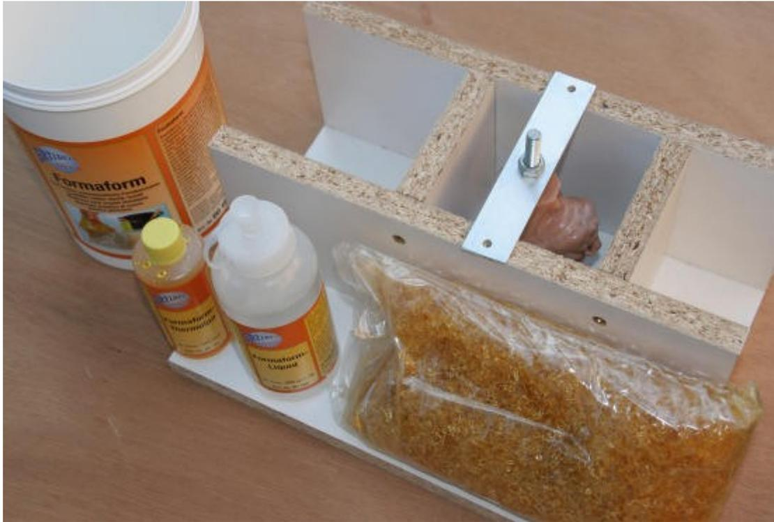
I granuli di [Formaform](#) (acquistati da OPITEC) vengono miscelati con [Formaform Liquid](#), quindi riscaldati a fuoco basso per circa dieci minuti fino a ottenere una pasta omogenea. Ho avvolto la testa di [Formaform](#) fuso prima di metterlo nello stampo e di versarvi il resto, per evitare grosse bolle che si sarebbero incastrate sotto la testa.
