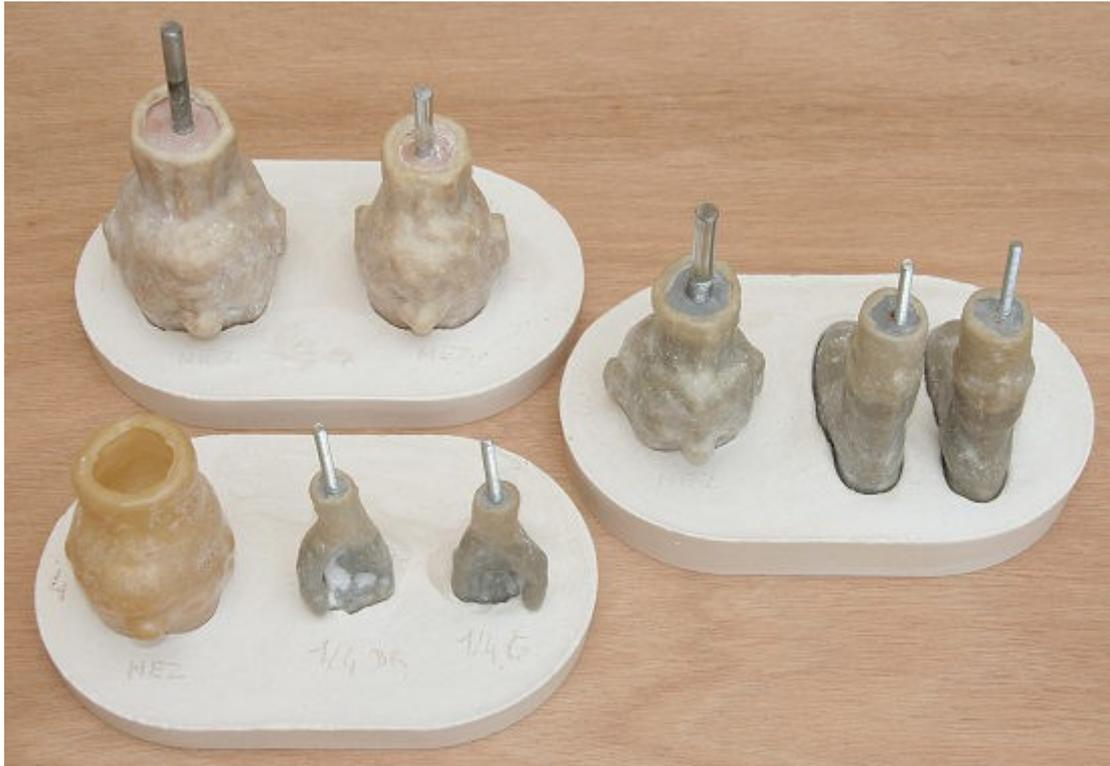
Prima di srotolare le matrici, ho fatto una maschera degli stampi in gesso per poterli contenere durante l'asciugatura della resina e della schiuma
