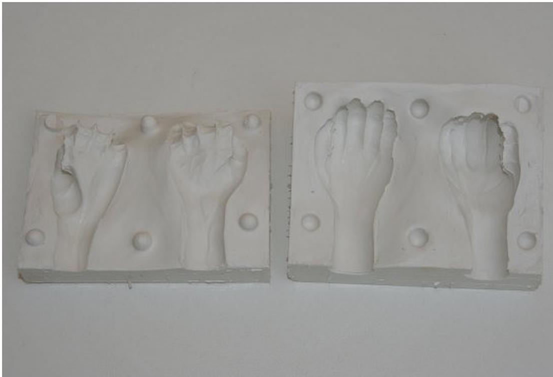
La resina può essere colata, non è necessario pressare il silicone. È una resina poliuretanicica con 2 componenti, miscelata in parti uguali. La miscela viene fatta rapidamente, la resina rimane molto liquida per 1 minuto, correre nella rete di estremità senza riempire e ruotare lo stampo in modo che la resina penetri bene fino alla punta delle dita, terminare il riempimento, dopo 3 minuti la resina si ispessisce, la sformatura può avvenire dopo 1/2 ora.
