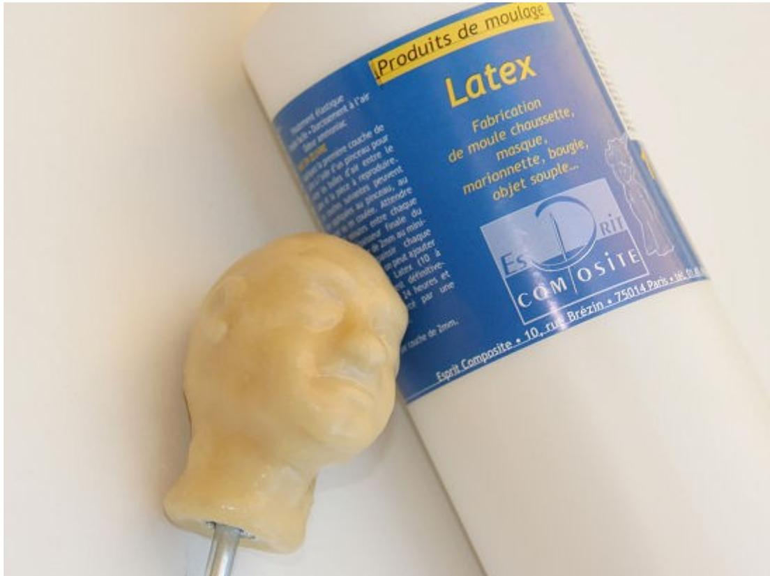
Una volta asciutto, dopo 24 ore, cospargere di talco all'esterno per evitare che il lattice si attacchi a sé stesso durante lo srotolamento.
