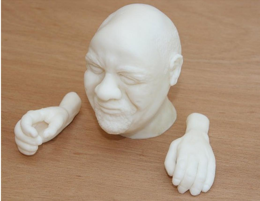
Alla sgrossatura, la linea di giunzione della testa è quasi invisibile. Peso della testa 1/3 di scala, 45 g e le mani 30 g.
