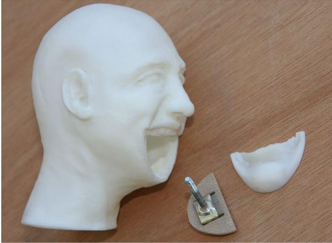
Stampaggio di una testa con solo resina PU, senza schiuma PU all'interno + un altro stampaggio della parte inferiore del viso (mento) perché non è possibile recuperarlo dal taglio.
