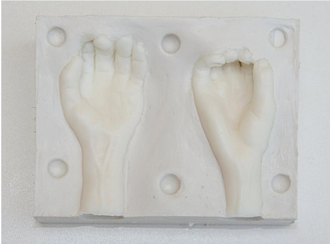
Il piano di giunzione è liscio e aderente ma è necessario sbavare i pezzi per rifinirli, in quanto la resina penetra nelle minime fessure.
