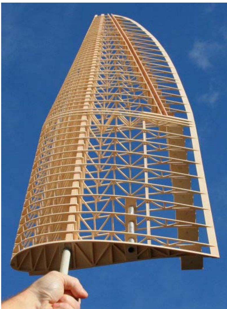
L'aile "démoulée" du chantier
