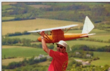
Le Gral 3 construit par Sylvère Maisse : 2,57 m de structure bois avec entoilage au Solarflex.
