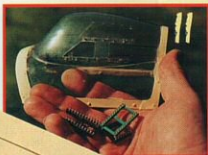
5 à 7) Le CM 8-13 a vraiment une silhouette très particulière, en grande partie à cause de sa verrière à double courbure. 8 & 9) La dérive et son grand volet de direction. 10) La commande du stab pendulaire. 11) L'aérateur est fixé par des rivets de support de C.I. 12) Reproduction du pitot, très particulier.
