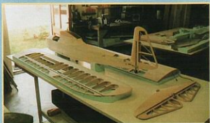
L'ensemble de la structure est terminée, il ne reste plus qu'à entoilier. Noter les chantiers d'aile en roofmat, au profil de l'intrados.
