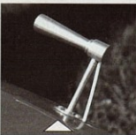
Le Pitot, placé à l'avant sur le dessus du fuselage.
