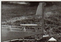
Détail d'une commande d'ailerons.
