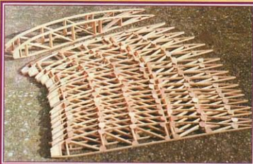
Après quelques longues soirées de travail, voilà les nervures d'une demi-aile de SG 38 échelle 1/4 prêtes à l'emploi !
