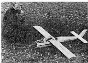
Le Bijave en cours de montage sur le terrain. La partie centrale de l'aile est vissée sur le fuselage mais il faut encore mettre en place les 2 parties extérieures.
