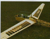
Les amovibles de balsa construction bois vont se régaler avec ce fuselage superbement architecturé et ces ailes plus classiques à simple trapèze mais réclamant néanmoins un travail précis.
