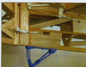
Ce zoom sur la béquille permet de voir la sortie des commandes de direction et profondeur mais aussi la petite tringlerie du tab situé au bord de fuite de la gouverne de profondeur droite.
