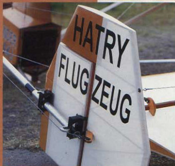
Leitwerk: Gesteuert wurde über Seilzüge und Rollen. Die ur- sprüngliche Aufschrift „Hatry“, Hinweis auf den Konstrukteur, löschte Fritz von Opel später; die beiden hatten sich zerstritten
