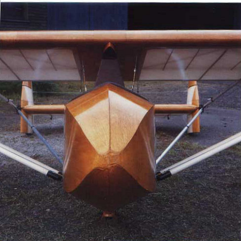
Harte Schale: Der nur 3,50 Meter lange Rumpf besteht aus Holz. In- nen drin kauerte der Pilot, im Heck saßen die Raketen
