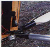
Gute Verbindung: Metallverstreibungen vom Flügel und Leitwerk finden im Rumpf festen Halt
