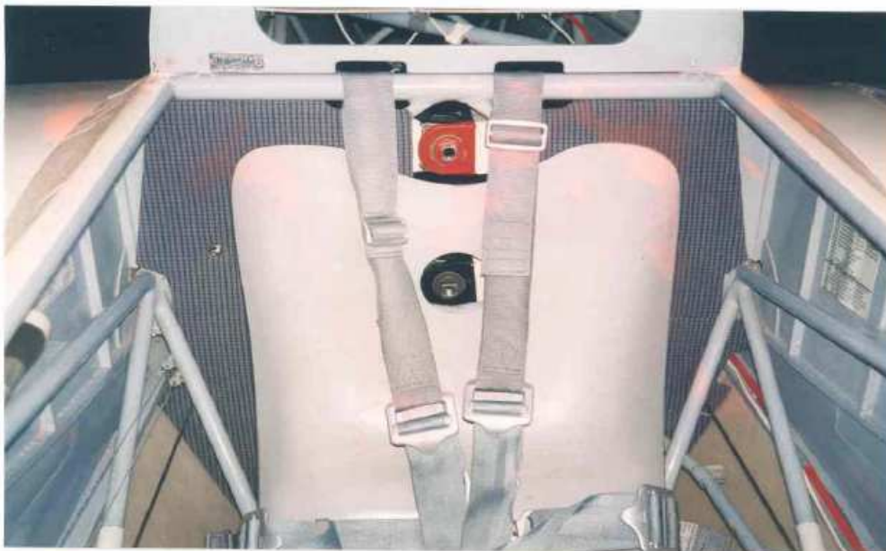
Abschottung nach hinten am Sitzspant - Sitzwanne eingebaut
