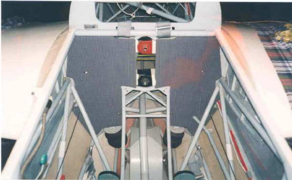
Abschottung nach hinten am Sitzspant - Sitzwanne ausgebaut
