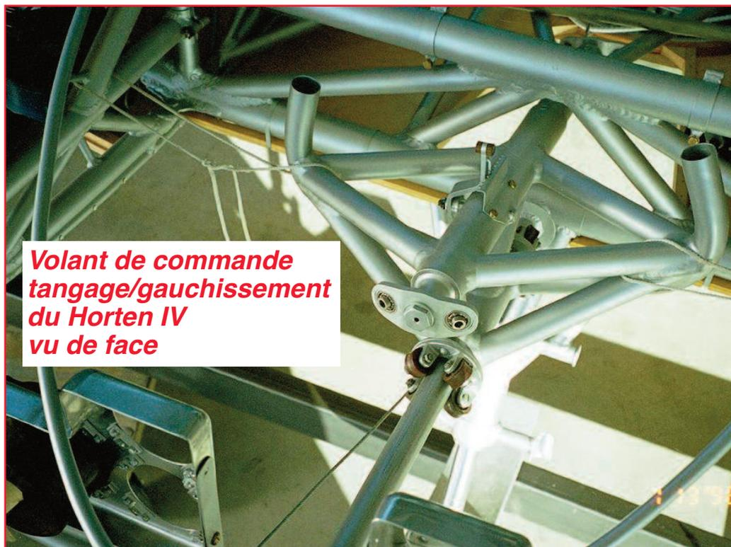
**Volant de commande tangage/gauchissement du Horten IV vu de face**
