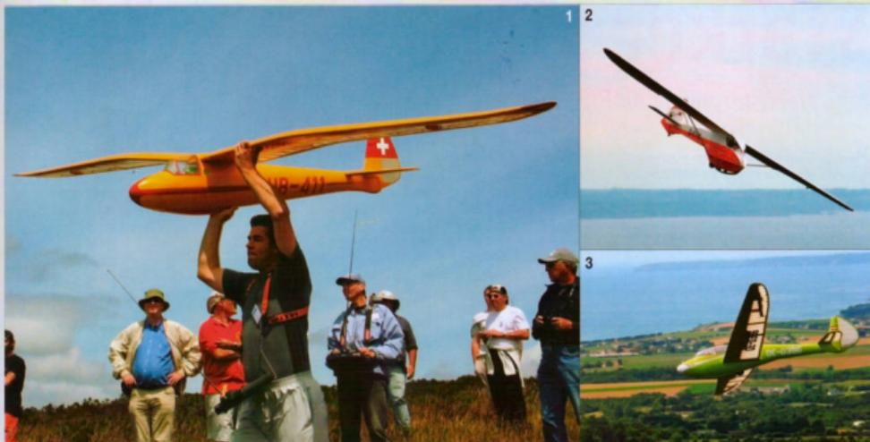
**1** Jacques van de Sype mit seinem „Spalinger S18 II“. Das Modell hat 4,2 m Spannweite, wiegt 7 kg und wurde nach einem Plan (IMVM Nr. 30) von M.H. Agniet gebaut. **2** Der „Doppelraub“ des Autors bei seinem Erstflug. Mit 3,5 kg und 2,55 m Spannweite ein Schwergewicht unter den „Doppelraub“-Modellen. Fliegen kann er trotzdem gut. **3** Die „Musger MG-19b“ von Gérard Mantelli, ein Modell mit 3,74 m Spannweite, gebaut nach einem vergrößerten Plan von Vincent Besançon.
