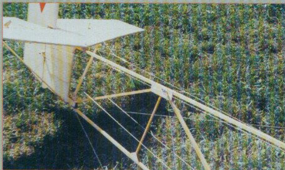
Über und unter dem Leitwerksträger die beiden V-Seil-Ansteuerungen für das Höhenruder. Das Seil zur Seitenruderansteuerung ist in der Mitte zu sehen. Jetzt sind es ja nur noch vier Stabilisierungsspannselle vom Flügel zum Leitwerksträger
