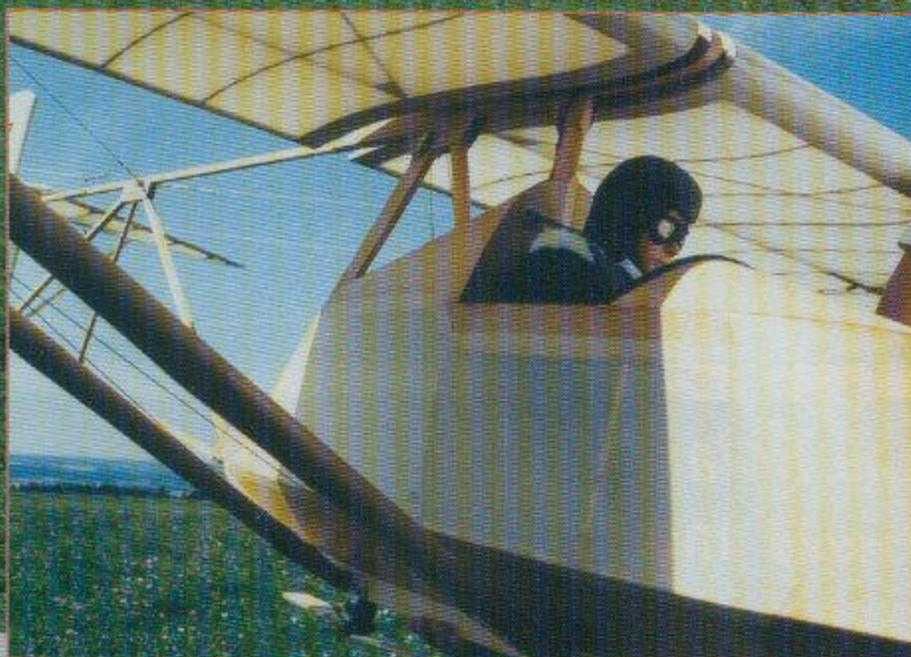
Das Rumpfboot. Nach hinten oben ist der Turm mit Flügelanschlussstück und der einfache, labile Leitwerksträger aus Kiefernleisten zu sehen
