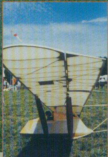
Flügelstreben und Verspannung mit dem Rumpfboot. Im Flügel sind die eingebauten Querverstreben zu sehen
